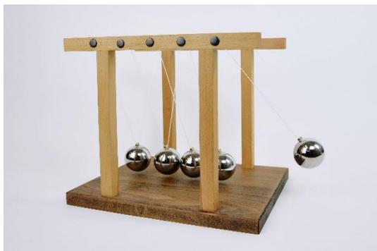
Маятник Ньютона - механическая система, предназначенная для демонстрации преобразования энергии различных видов друг в друга: кинетической в потенциальную и наоборот. В отсутствие противодействующих сил (трения) система могла бы действовать вечно, но в реальности это недостижимо.
