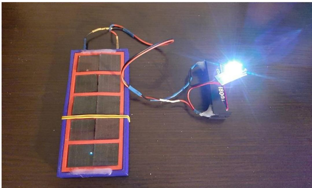
Для создания модели были использованы: солнечная панель с кремниевыми пластинами, аккумулятор энергии и потребитель-светодиод.
